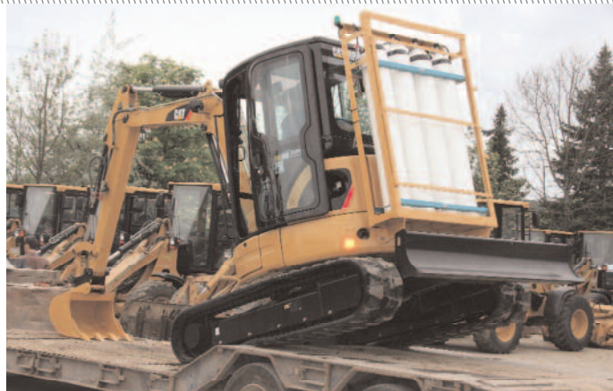
Weiten-Filterlösung ADLA 55 an einer Caterpillar-Raupe, damit stehen ca. 60 m 3 Atemluft zur Verfügung. Das reicht für rund vier Stunden Betrieb bei einem Verbrauch von 200 l/min.
