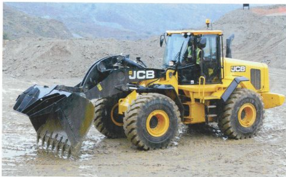
Der JCB 457 hat deutlich mehr Kraft als sein Vorgänger. Mit der Kupplungsdruck-Abschaltung wird außerdem im Stand die maximale Kraft auf die Arbeitshydraulik geleitet. | Foto: bi/Ste
