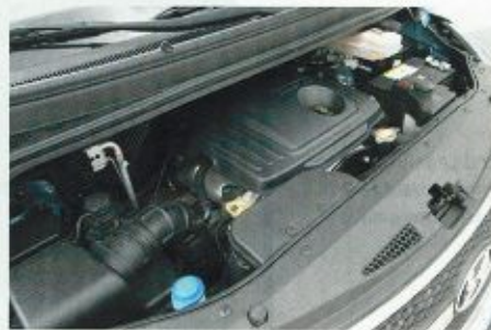
Der großvolumige längs montierte Vierzylinder verbirgt sich unter dem großen Luftfilterkasten
