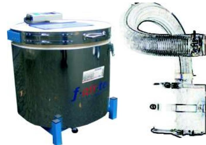
Das Aufsteckfilter dient zur Rußabscheidung und Geruchsminderung bei Abgasen von Dieselmotoren. Es wurde speziell für den mobilen Einsatz entwickelt, damit Fahrzeuge in Hallen betrieben werden können.
