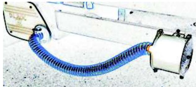
Es empfiehlt sich, das Filtergehäuse waagrecht oder nach unten gerichtet einzubauen, da z.B. durch Regen das Filtermaterial benetzt werden könnte.
