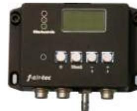
Der Vorratsdruck wird direkt über einen Sensor an den Hochdruckflaschen gemessen. Der Fahrer bekommt ein Warnsignal zum Verlassen des kontaminierten Bereiches sobald der Druckluftvorrat 25 bar unterschreitet. Damit ist sichergestellt, dass der Fahrer den kontaminierten Bereich verlassen kann ohne auf den Schutz verzichten zu müssen.
